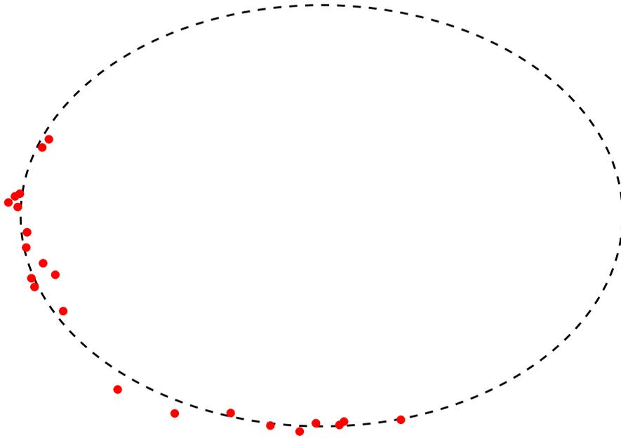
FIGURA 2. Dado un conjunto de observaciones de la posición de un planeta, el método de mínimos cuadrados permite determinar la ecuación de la elipse que mejor se ajusta a dicho conjunto de observaciones
